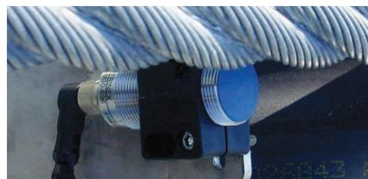
Monitoraggio tensione della cinghia di trasmissione
